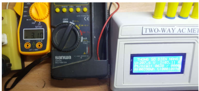
b) Kết quả đo công suất thuận trên thiết bị và trên điện thoại với tải R
