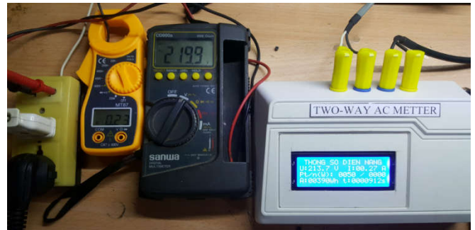
a) Kết quả đo công suất thuận trên thiết bị và trên điện thoại với tải R-L
