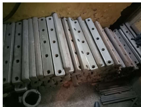
Hình 3. Búa nghiền sau khi hàn lớp bề mặt
