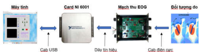
Hình 4. Sơ đồ khối hệ thống thu nhận tín hiệu điện nhãn đồ
