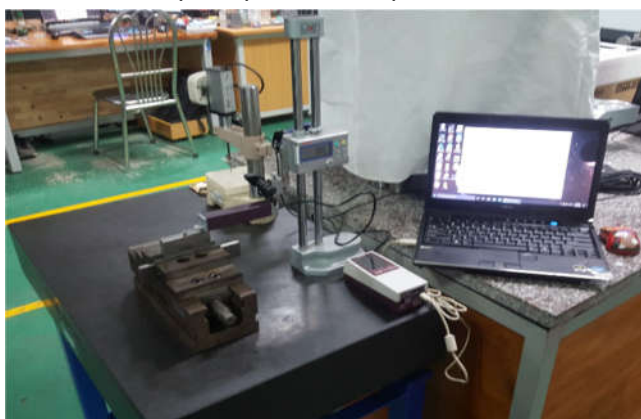
Hình 3. Hình ảnh đo độ nhám bề mặt chi tiết sau khi gia công
