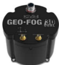
Hình 9. IMU dành cho ô tô tự hành
