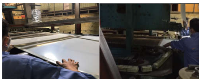
Bước 5. Đưa tôn vào khuôn
