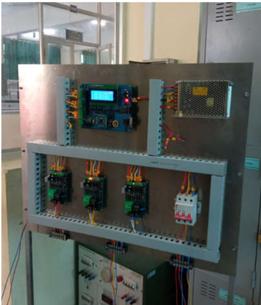
Hình 9. Mô hình kiểm soát mômen ứng dụng vi điều khiển Atmega64 và ZHKY901
