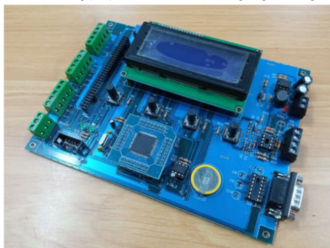
Hình 8. Mạch đo kiểm soát mômen ứng dụng vi điều khiển Atmega64
