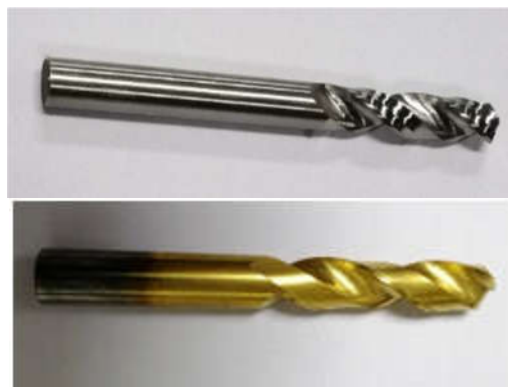
Hình 6. Mũi khoan trước (trái) và sau khi phủ TiN (phải)
