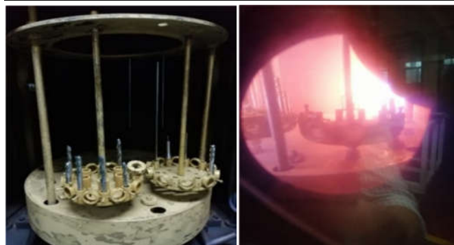
Hình 2. Các mũi dụng cụ được gá đặt trên bộ gá quay trong buồng chân không (trái) và hình ảnh chụp hồ quang trong buồng khi thực hiện phủ (phải)
