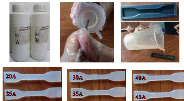
Hình 1. Chế tạo mẫu thử từ các vật liệu khác nhau
