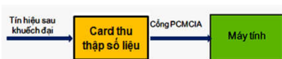
Hình 6. Sơ đồ ghép nối card thu thập số liệu với hệ thống
