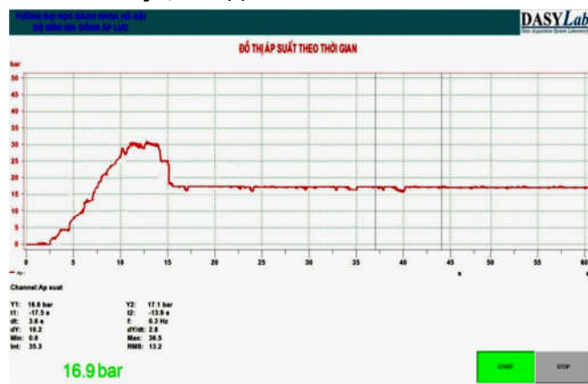
Hình 11. Đồ thị áp suất chất lỏng công tác trong suốt quá trình lăn ép
