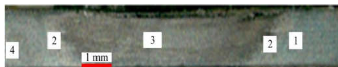
Hình 3. Cấu trúc thô đại liên kết hàn giáp mối thép boron bằng quá trình hàn ma sát khuấy
