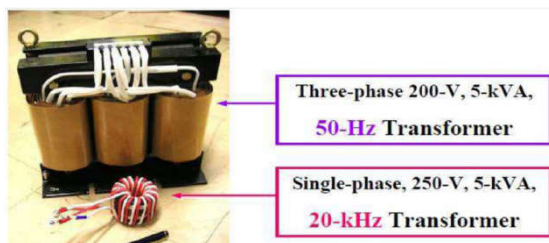
Hình 2. Kích thước giữa máy biến áp tần số cao và máy biến áp tần số thông thường [2]
