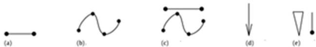
Hình 4. Ký hiệu các loại đường nét [12] (a) Đường thẳng (b) Đường con (c) Chiết (d) Canh sợi (e) Đánh dấu
