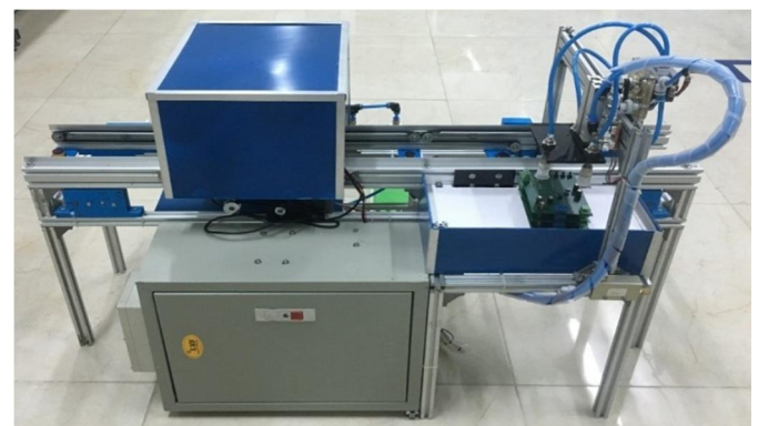
Hình 11. Hệ thống kiểm tra linh kiện điện tử hoàn chỉnh
