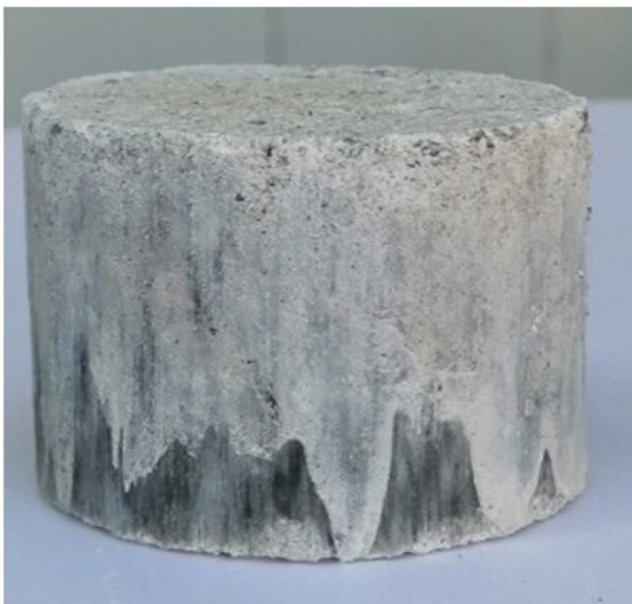
Hình 3. Mẫu vật liệu CX 501 bị "mốc cacbonat"
