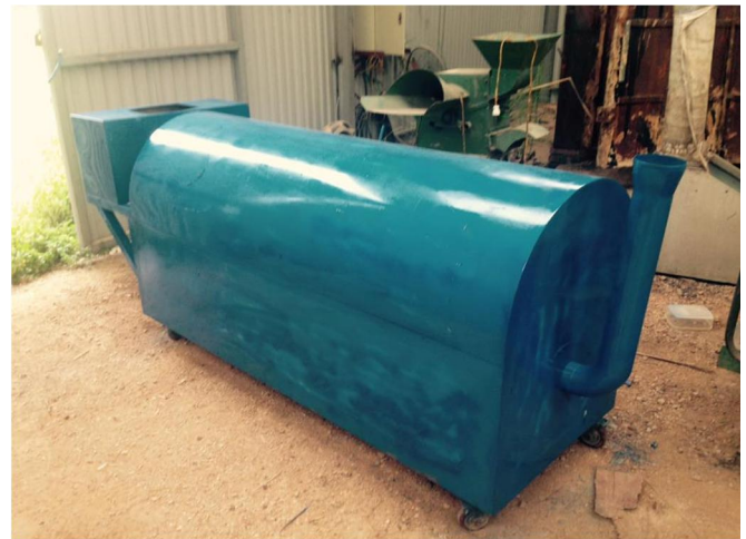
Hình 9. Hình ảnh chế tạo bể bằng vật liệu inox
