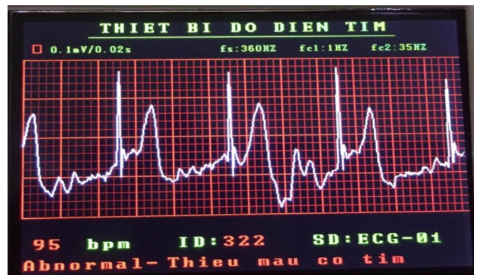
Hình 16. Hình ảnh tín hiệu điện tim trên màn hình LCD với các thông số: Số nhịp tim/phút là 95bpm, mã số bệnh nhân (ID) là 322, Abnormal - Thiếu máu cơ tim
