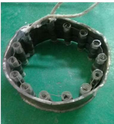
Hình 14. Bộ phận gia nhiệt khuôn sau khi lắp
