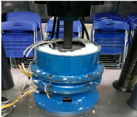
Hình 18. Lắp đặt hệ thống ép chảy chế tạo trên máy kéo nén
