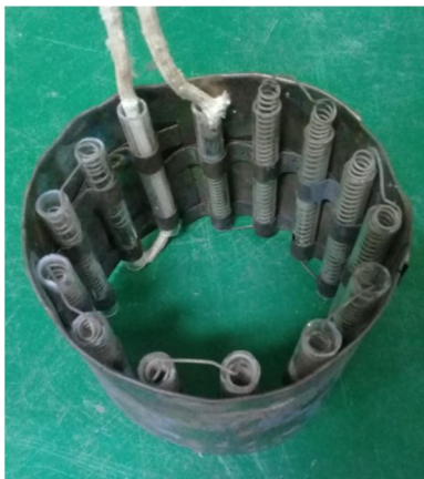
Hình 13. Bộ phận gia nhiệt ống chứa phôi sau khi lắp
