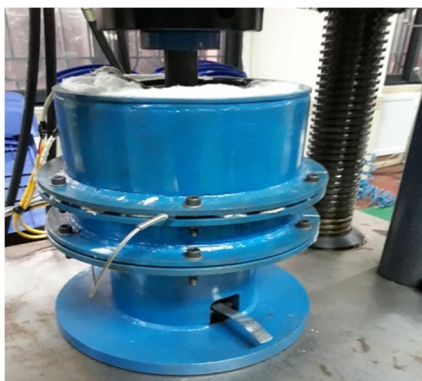
Hình 19. Hệ thống ép chảy trên máy kéo nén ép thử sản phẩm
