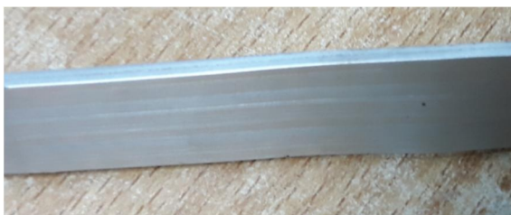
Hình 20. Sản phẩm thanh hợp kim nhôm sau khi ép
