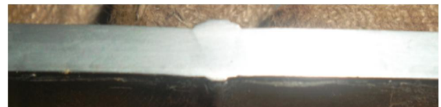
Hình 1. Ảnh mặt cắt mối hàn khi hàn hai lớp
