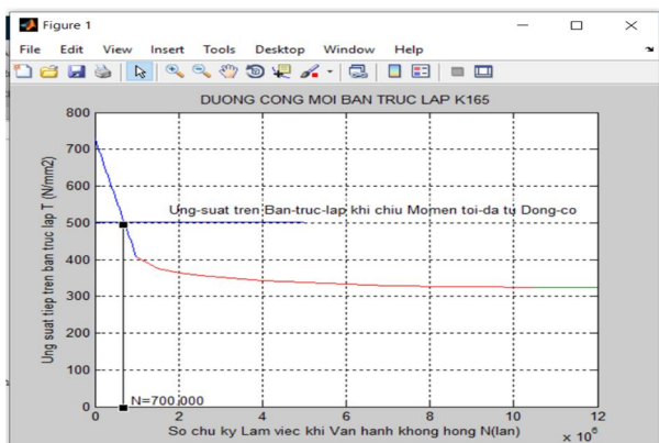
Hình 7. Đồ thị ĐCM bán trục ô tô K165 do ứng suất khi nhận momen tối đa từ động cơ
