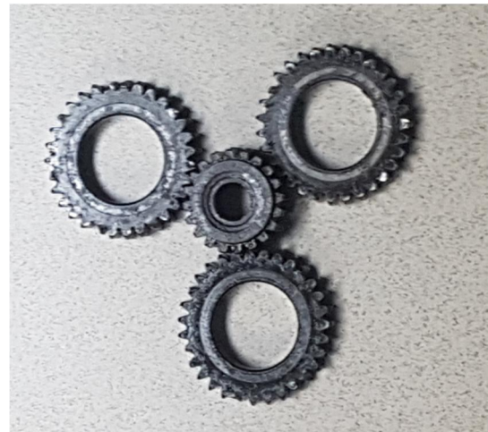
Hình 1. Bộ bánh răng hành tinh hỏng do mòn, gãy mẻ răng
