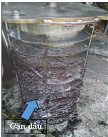
Hình 9. Phin lọc của silo sau khi thử nghiệm lọc dầu
