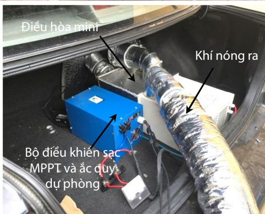
Hình 4. Hệ thống làm mát xe ô tô đồ ngoài trời sử dụng bạt gắn pin năng lượng mặt trời thử nghiệm tại đường Nguyễn Văn Trỗi, phường Phương Liệt, quận Thanh Xuân, Hà Nội
