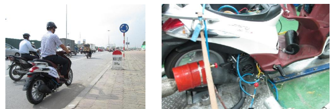
Hình 2. Xe Piaggio-Leberty thử nghiệm trên hiện trường và trên băng thử CD 20"
