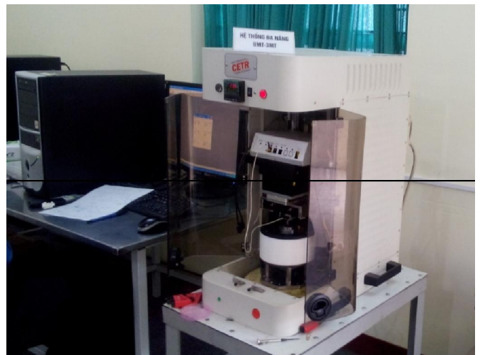
Hình 2. Thiết bị đo ma sát vận năng UMT (Brucker, Mỹ)
