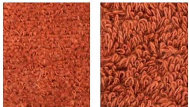
Hình 1. Hình ảnh bề mặt khăn xén sợi vòng và khăn bông không xén sợi vòng
