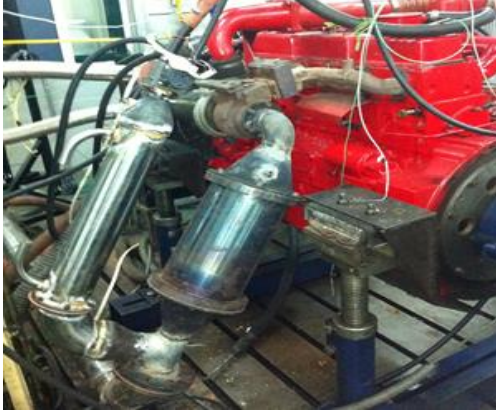
Hình 2. Vị trí lắp đặt bộ DOC và DPF trên đường thải trong quá trình thử nghiệm
