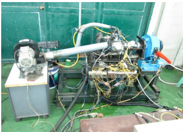
Hình 1. Hệ thống thử nghiệm động cơ xe máy Các thiết bị trong hệ thống thử nghiệm gồm:
