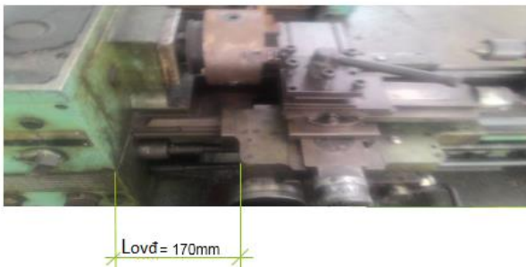
Hình 15. Khoảng cách từ mép của bàn xe dao đến thân máy khi mép của ụ gá dao tiếp xúc với mâm cặp đo được bằng thước trên máy tiện 16B05П
