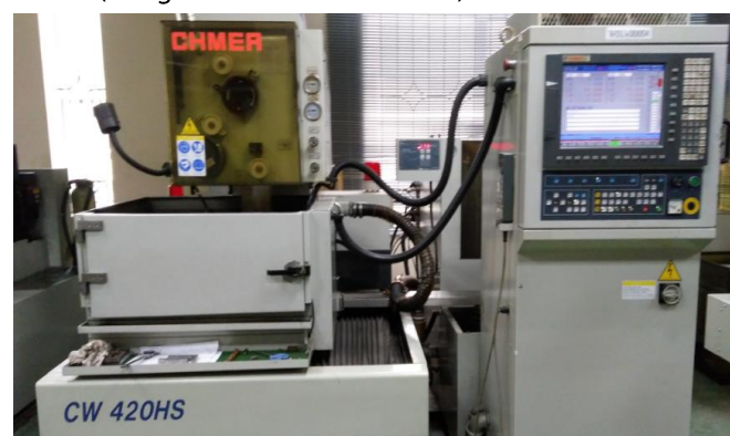
Hình 1. Máy gia công cắt dây CHMER CW-420HS
