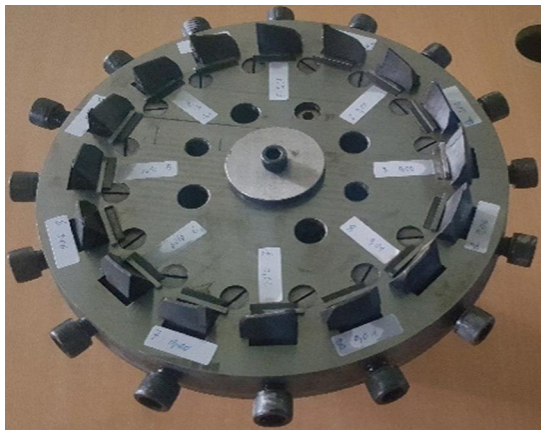
Hình 2. Dao phay bánh răng côn cong hệ gleason gắn mảnh hợp kim Kyocera
