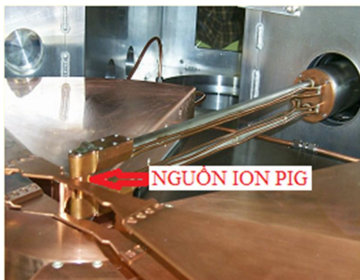
Hình 2. Cấu tạo cơ bản nguồn ion công nghệ PIG
