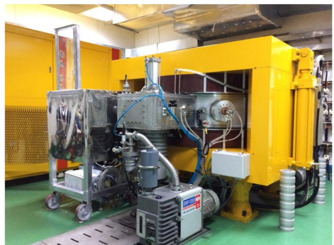
Hình 1. Hình ảnh máy gia tốc cyclotron KOTRON13
