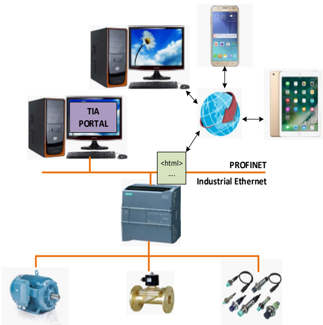
Hình 2. Cấu trúc hệ thống giám sát và điều khiển dây chuyền sản xuất qua Internet
