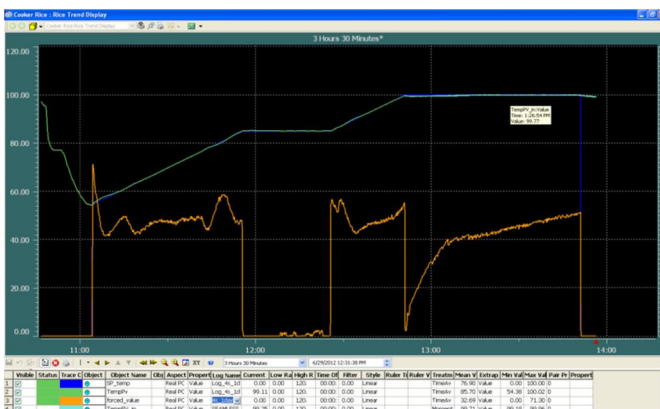
Hình 19. Đáp ứng nhiệt độ của dịch bia trong nồi nấu hồ hóa khi chạy thực nghiệm
