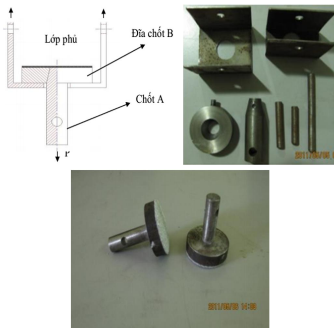
Hình 1. Sơ đồ và mẫu kiểm tra độ bám dính [3]
